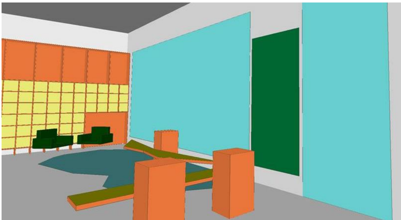
Rys. 6.1 Panele ściennie, dokładne rozmieszczenie - 2x 2400x600x25 mm
